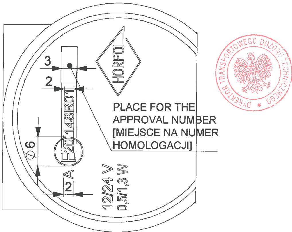
Rys. 14. Widok szczególnego ze znakiem homologacji (światło pozycyjne przednie)
