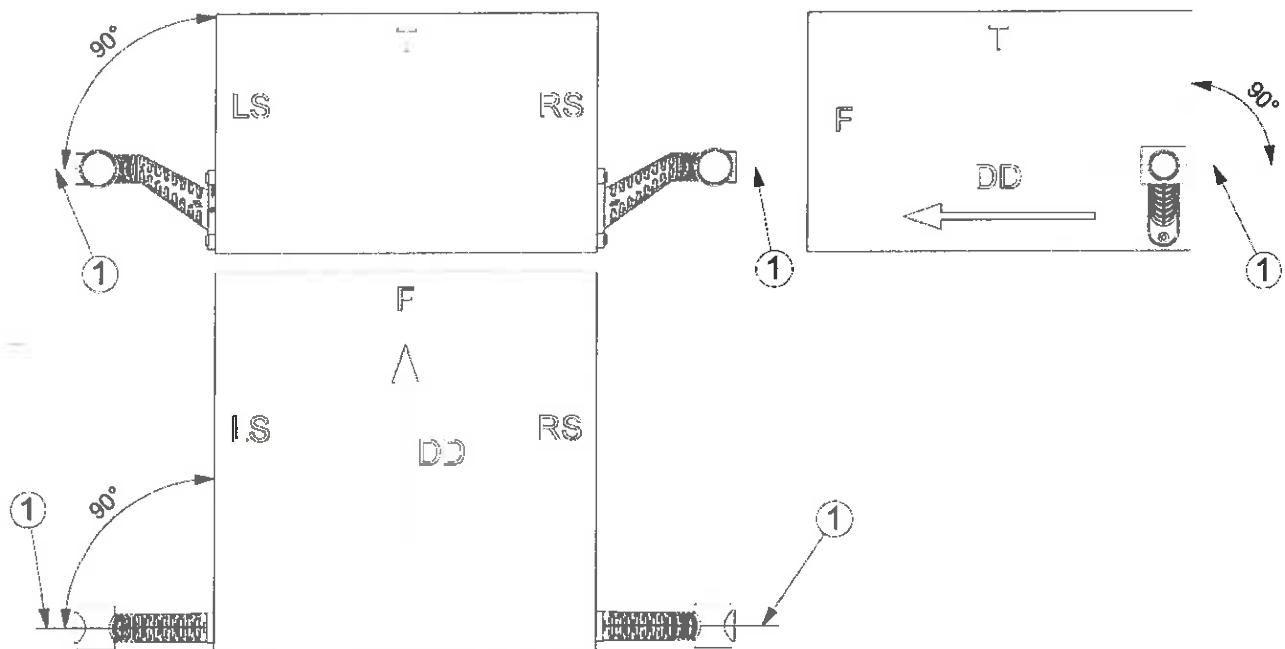
Rys. 17. Rysunek montażu lamp HOR 77AG w wariantach LD 2174/GRAFITE i LD 2175/GRAFITE na pojeździe
