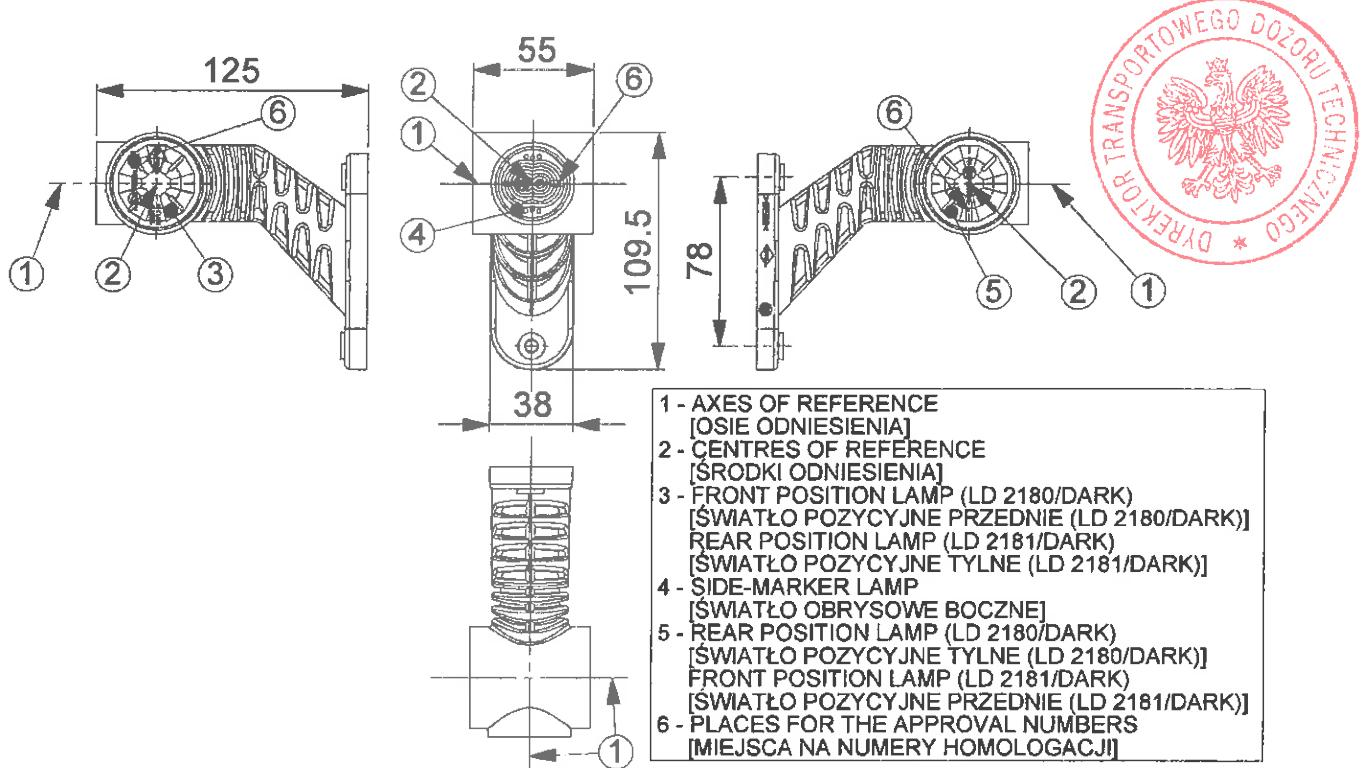
Rys. 10. Rysunek lampy HOR 77AG w wariantach LD 2180/GRAPHITE i LD 2181/GRAPHITE
