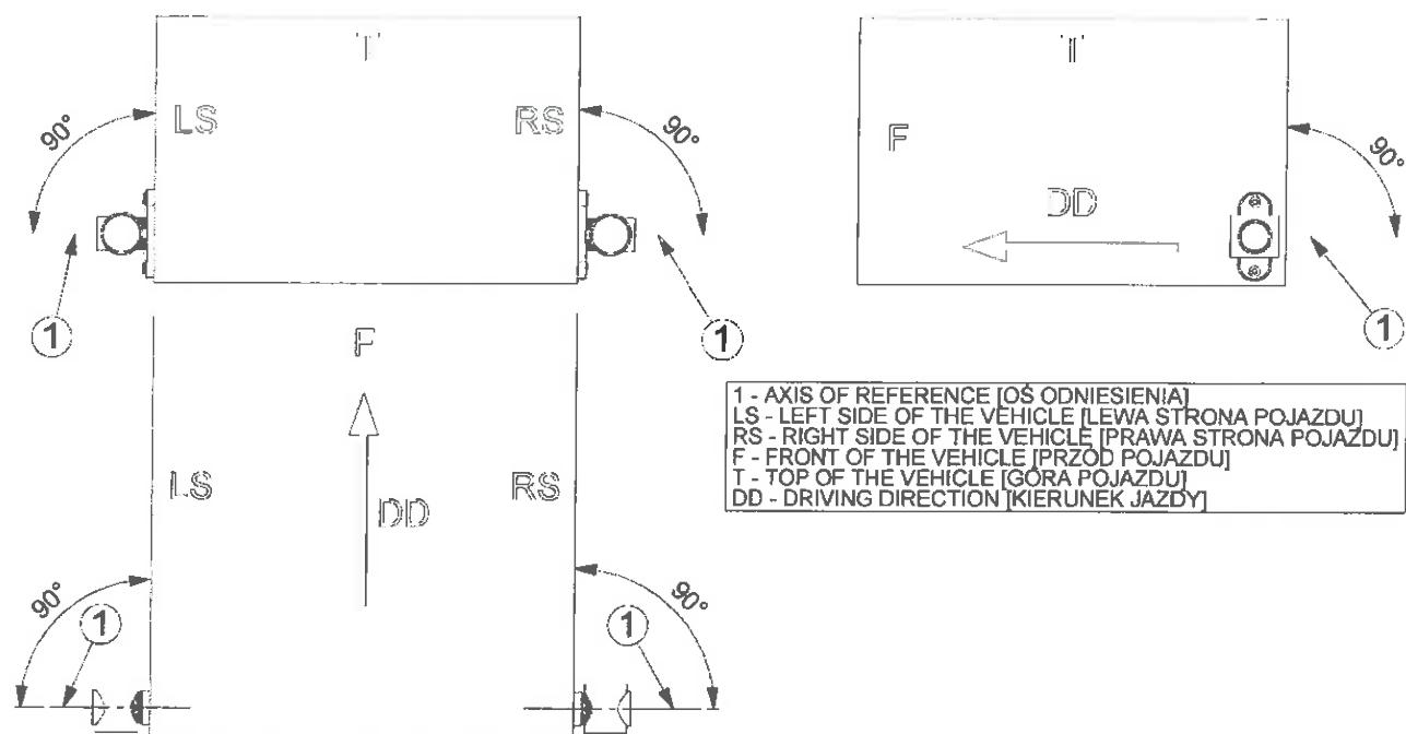
Rys. 19. Rysunek montażu lamp HOR 77AG w wariantach LD 2186/GRAFITE na pojeździe
