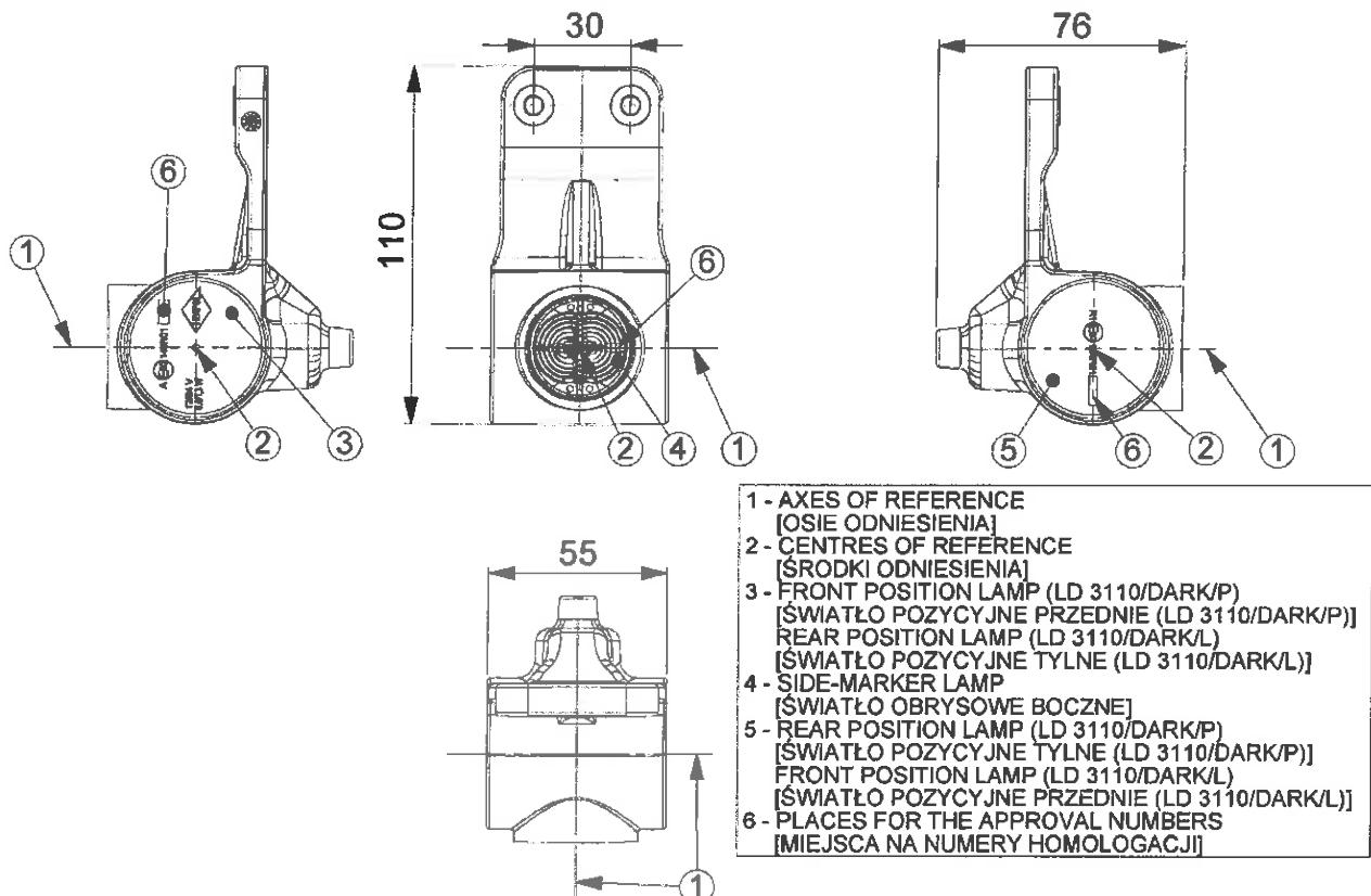
Rys. 13. Rysunek lampy HOR 77AG w wariantach LD 3110/GRAFITE/P i LD 3110/GRAFITE/L
