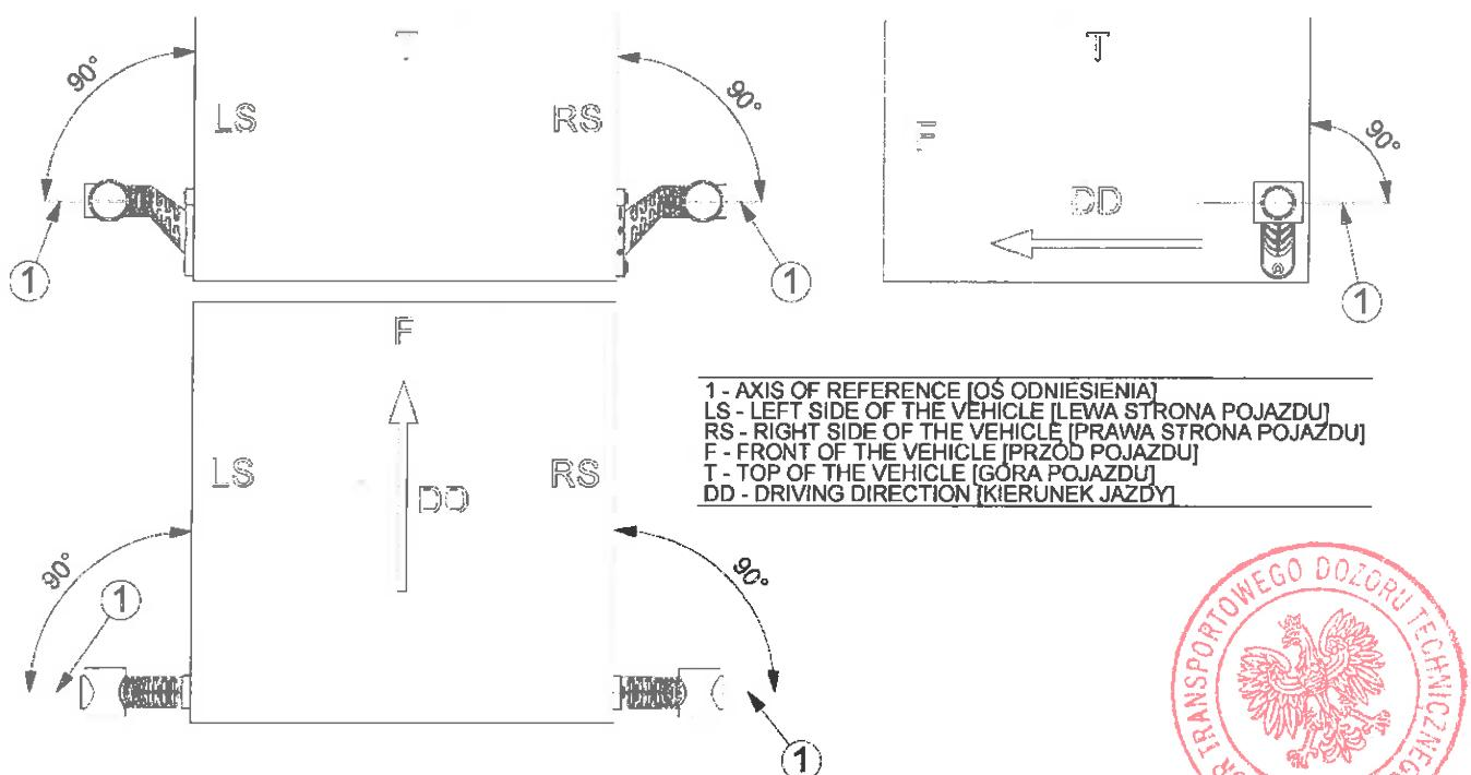
Rys. 18. Rysunek montażu lamp HOR 77AG w wariantach LD 2180/GRAPHITE i LD 2181/GRAPHITE na pojeździe
