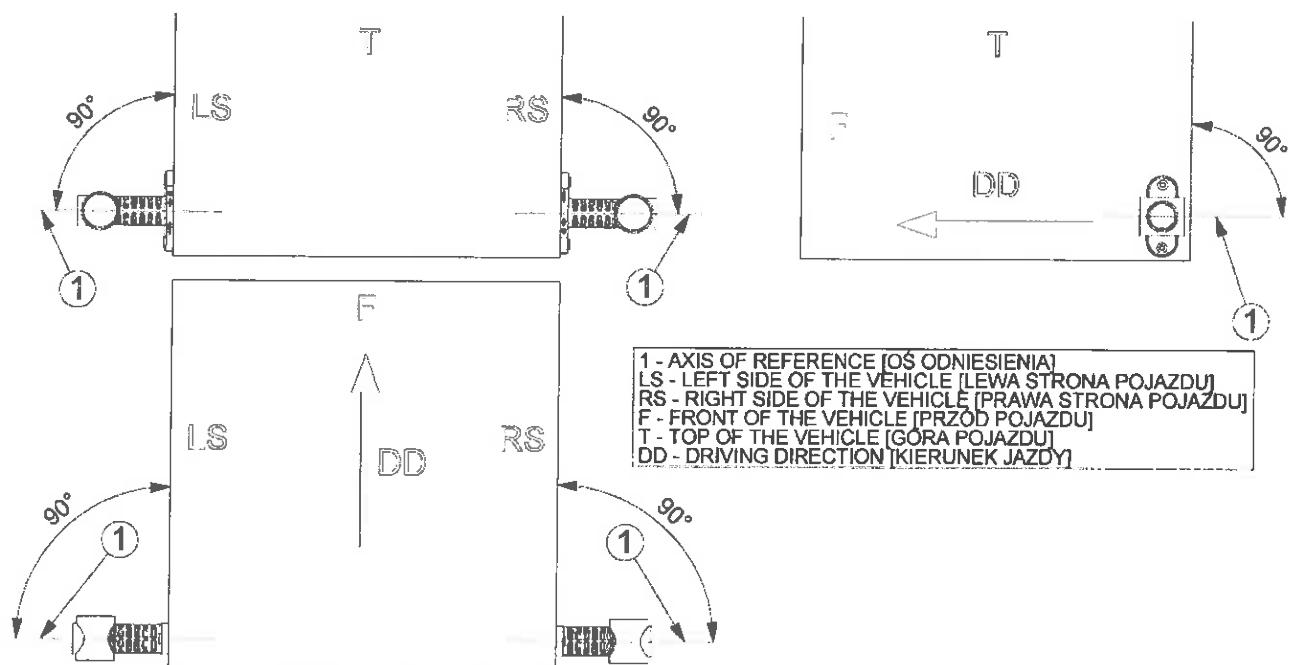
Rys. 20. Rysunek montażu lamp HOR 77AG w wariantach LD 2191/GRAPHITE na pojeździe
