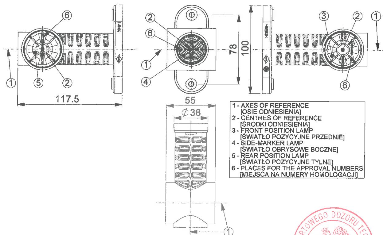
Rys. 12. Rysunek lampy HOR 77AG w wariantce LD 2191/GRAPHITE
