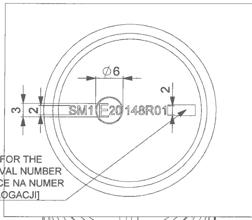
Rys. 16. Widok szczegółu ze znakiem homologacji (światło obrysowe boczne)
