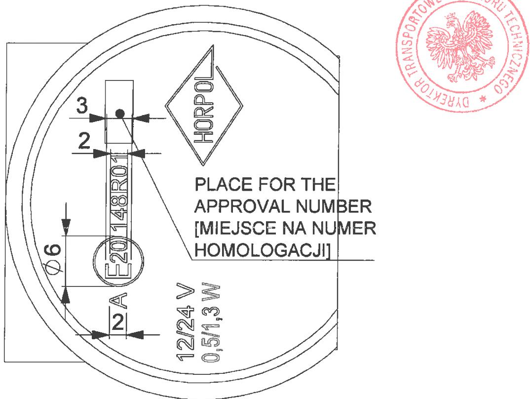
Rys. 14. Widok szczególnego ze znakiem homologacji (światło pozycyjne przednie)
