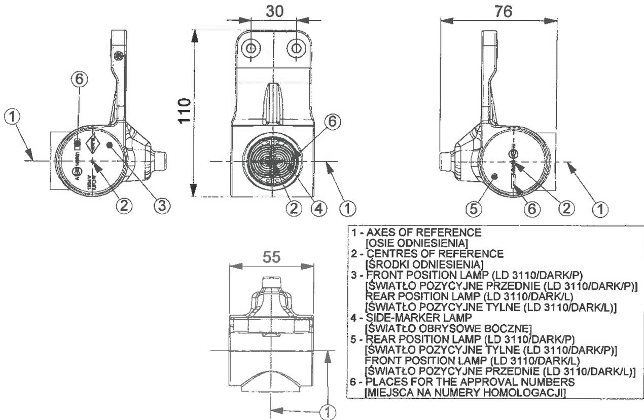
Rys. 13. Rysunek lampy HOR 77AG w wariantach LD 3110/GRAPHITE/P i LD 3110/GRAPHITE/L
