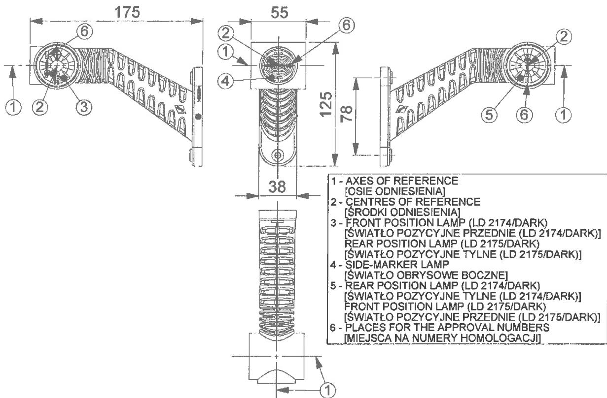
Rys. 9. Rysunek lampy HOR 77AG w wariantach LD 2174/GRAPHITE i LD 2175/GRAPHITE
