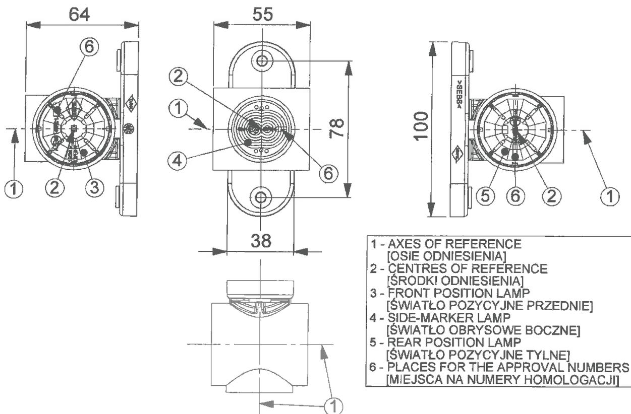
Rys. 11. Rysunek lampy HOR 77AG w wariacie LD 2186/GRAPHITE
