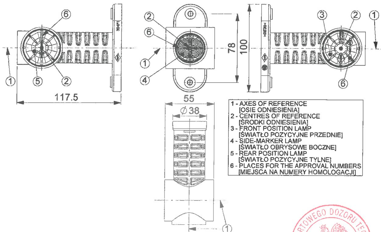
Rys. 12. Rysunek lampy HOR 77AG w wariacie LD 2191/GRAPHITE
