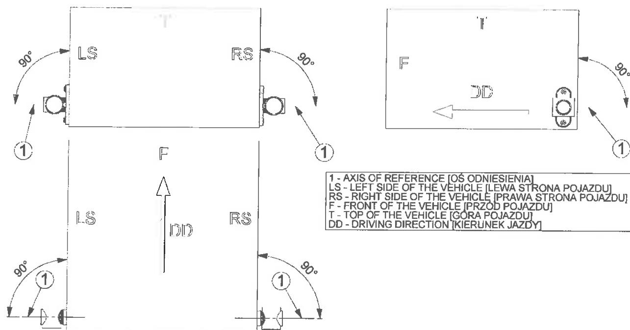
Rys. 19. Rysunek montażu lamp HOR 77AG w wariantach LD 2186/GRAPHITE na pojeździe
