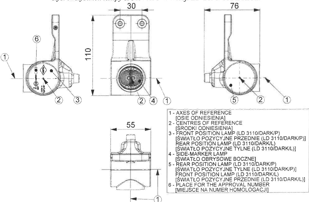
Rys. 10. Rysunek lampy HOR 77AG w wersji LD 3110/GRAFITE/L i LD 3110/GRAFITE/P.
