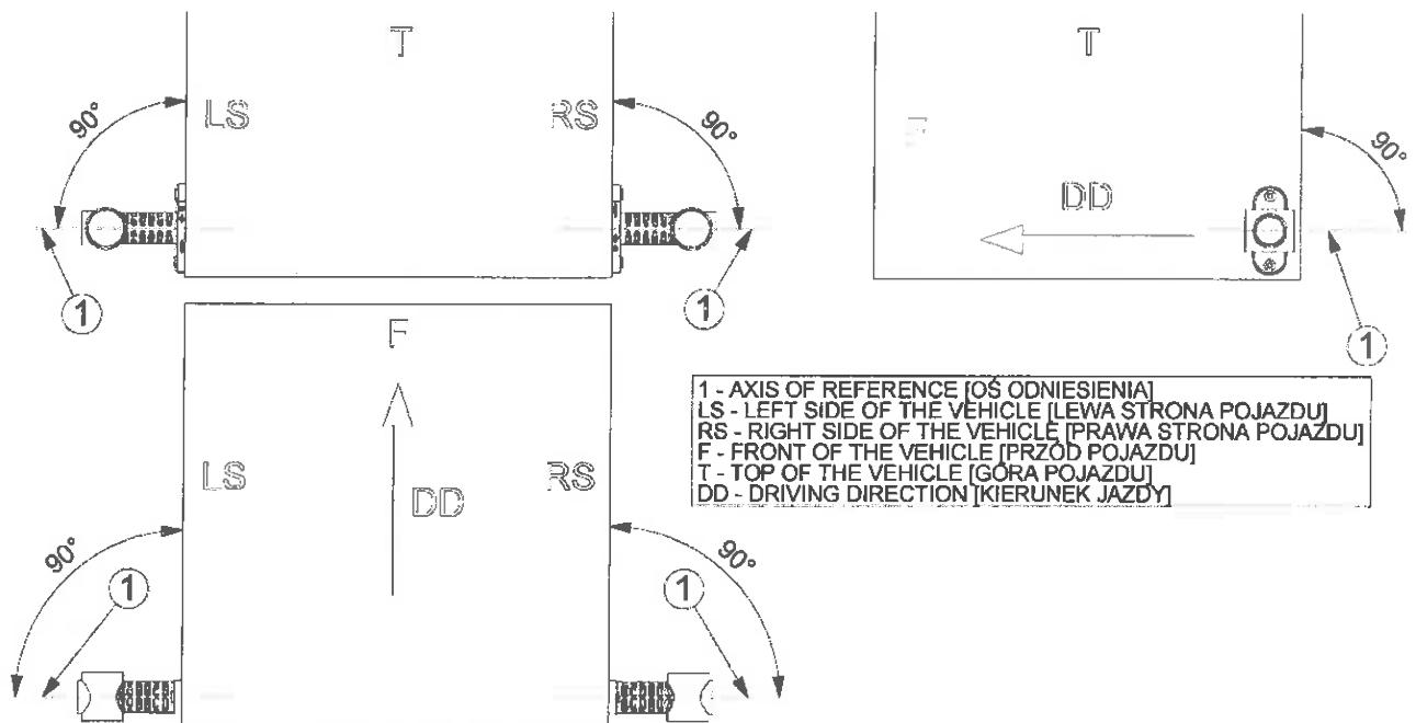
Rys. 20. Rysunek montażu lamp HOR 77AG w wariantach LD 2191/GRAFITE na pojeździe
