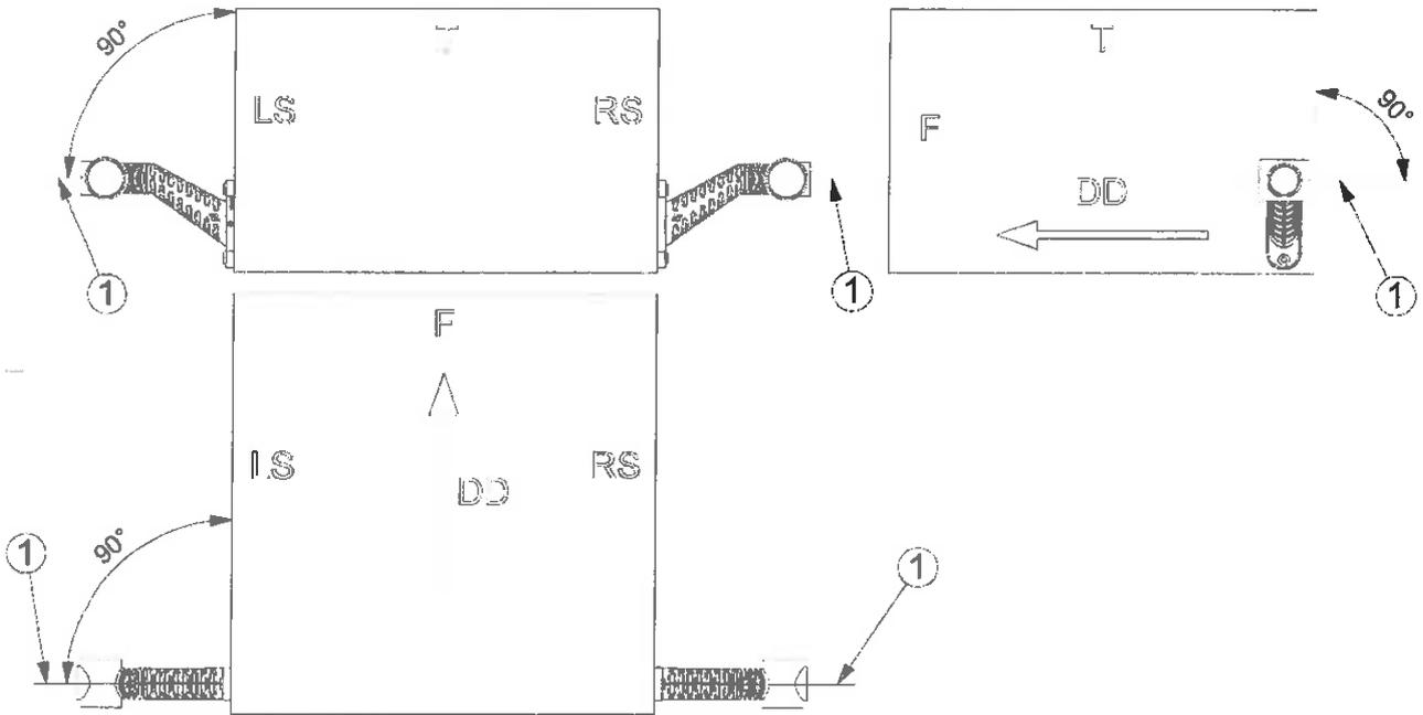
Rys. 17. Rysunek montażu lamp HOR 77AG w wariantach LD 2174/GRAPHITE i LD 2175/GRAPHITE na pojeździe
