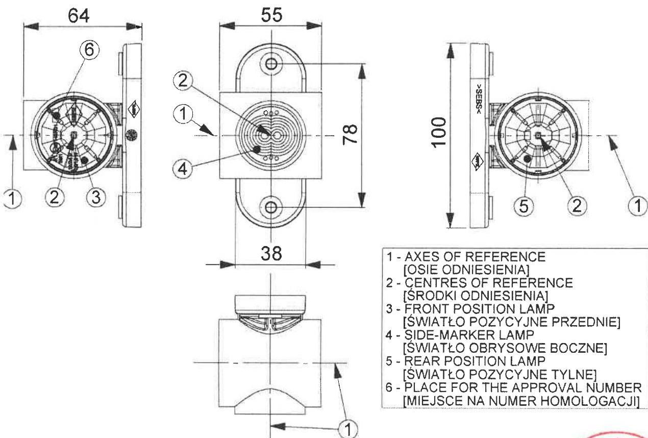
Rys. 8. Rysunek lampy HOR 77AG w wersji LD 2186/GRAFITE.
