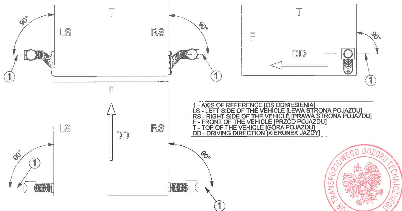
Rys. 18. Rysunek montażu lamp HOR 77AG w wariantach LD 2180/GRAFITE i LD 2181/GRAFITE na pojeździe
