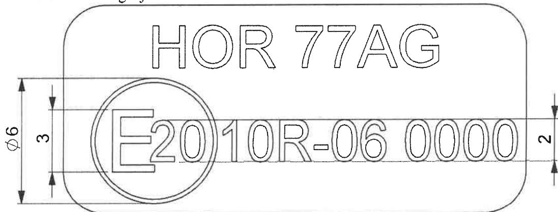
Rys. 14. Rysunek przykładowego znaku homologacji
