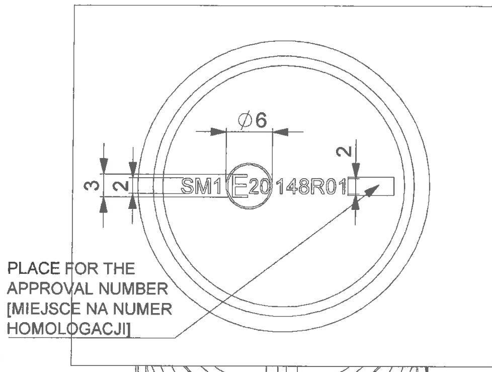
Rys. 16. Widok szczegółu ze znakiem homologacji (światło obrysowe boczne)
