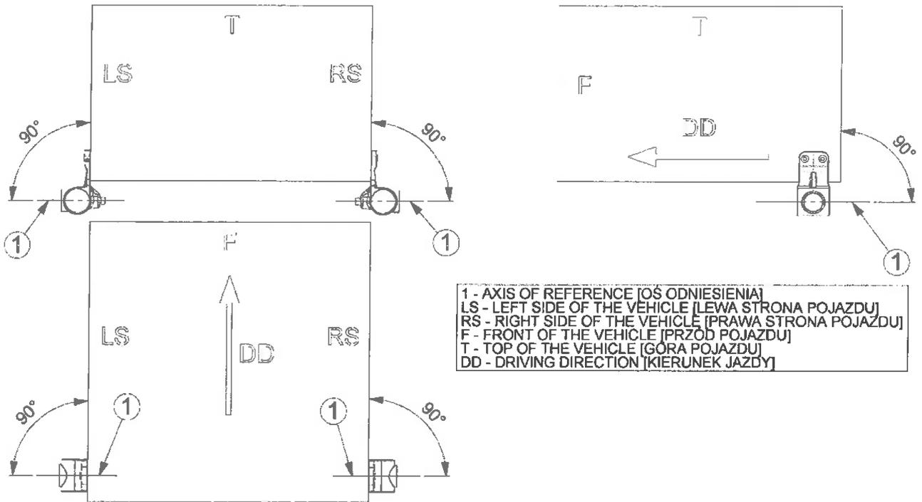
Rys. 21. Rysunek montażu lamp HOR 77AG w wariantach LD 3110/GRAPHITE/P i LD 3110/GRAPHITE/L na pojeździe
