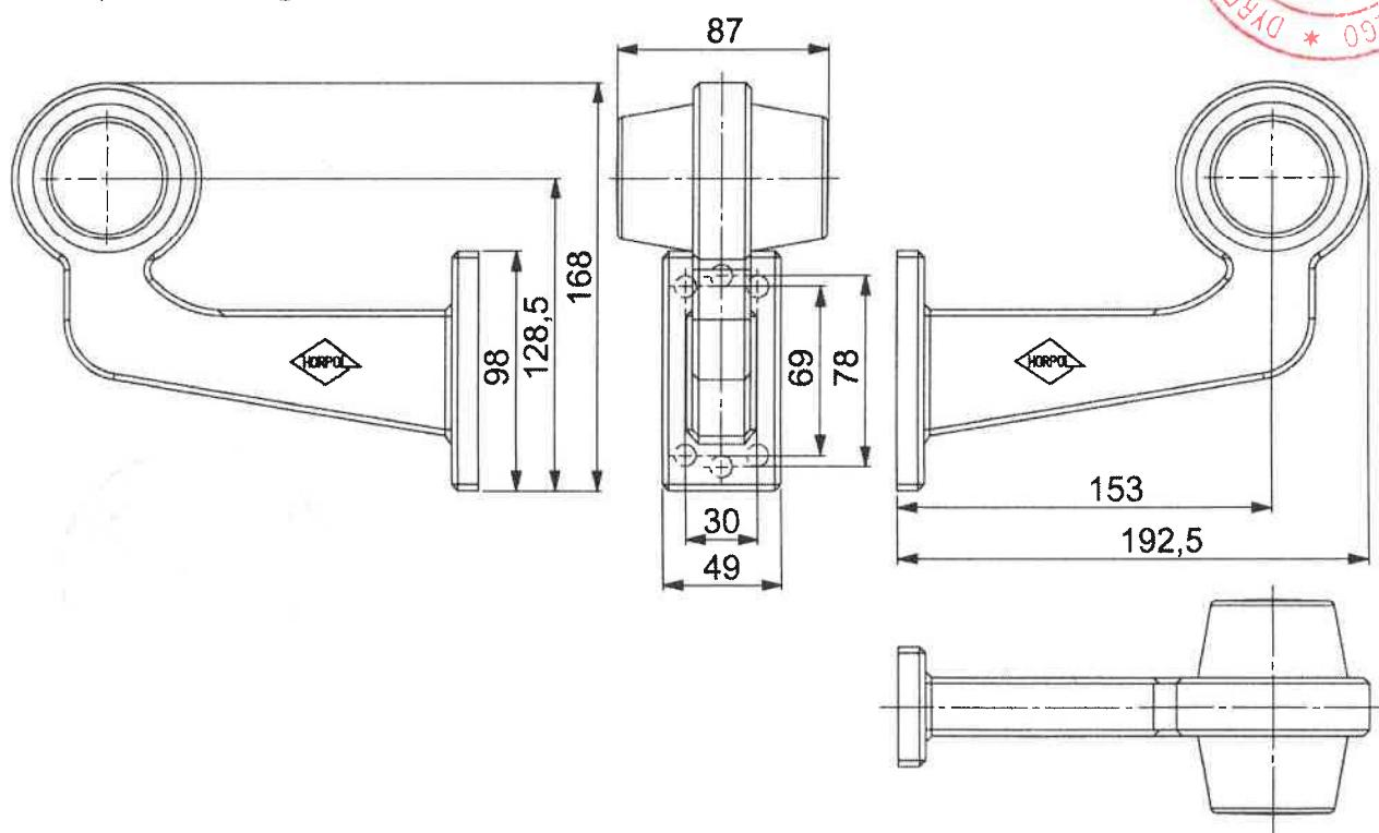
Rys. 3. Rysunek lampy HOR 102AG w wersji na długim wysięgniku.
