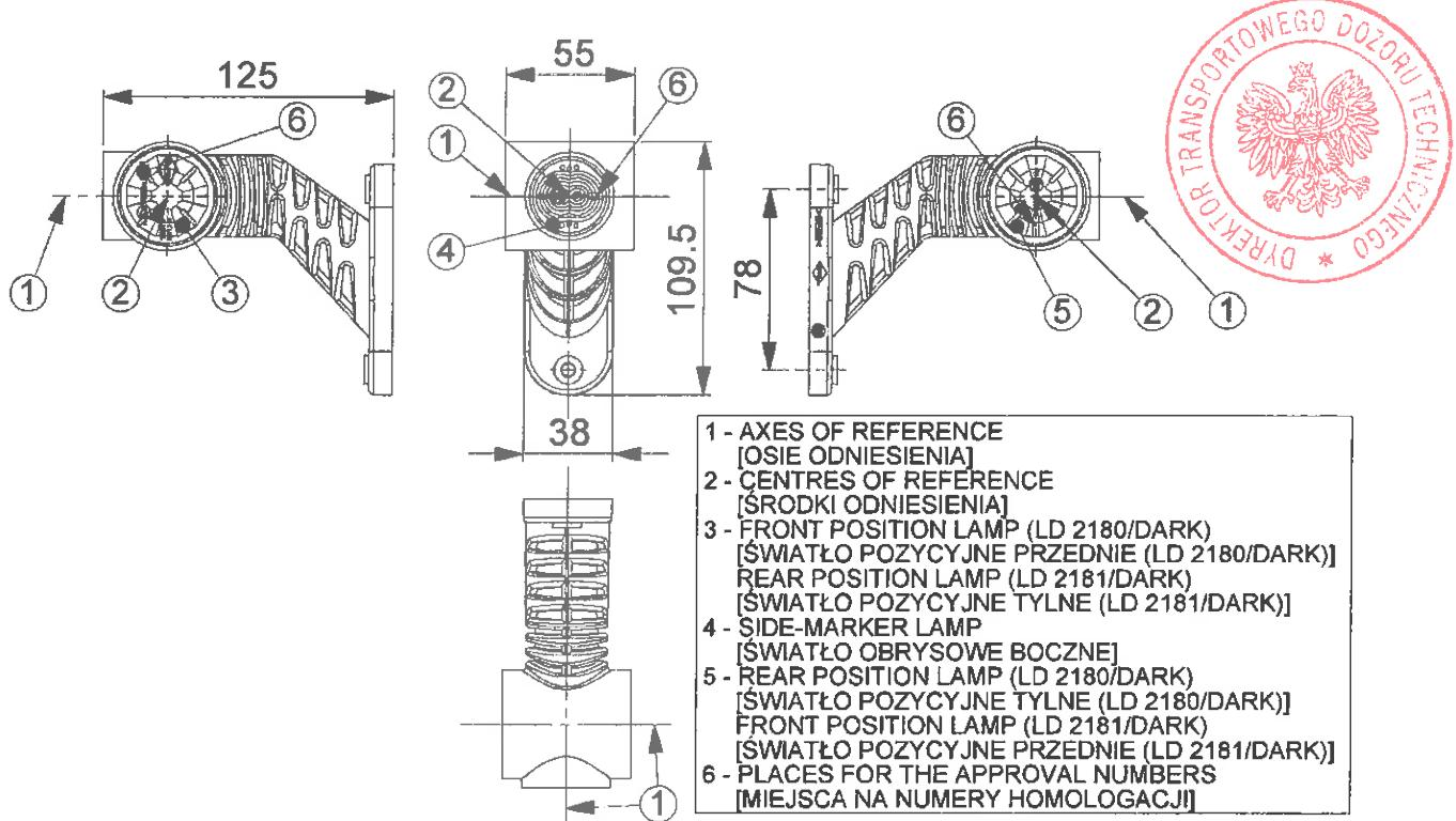
Rys. 10. Rysunek lampy HOR 77AG w wariantach LD 2180/GRAPHITE i LD 2181/GRAPHITE
