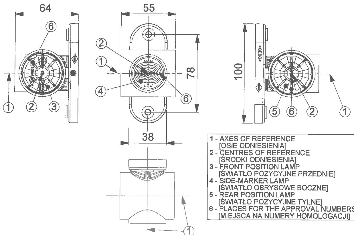
Rys. 11. Rysunek lampy HOR 77AG w wariantce LD 2186/GRAPHITE
