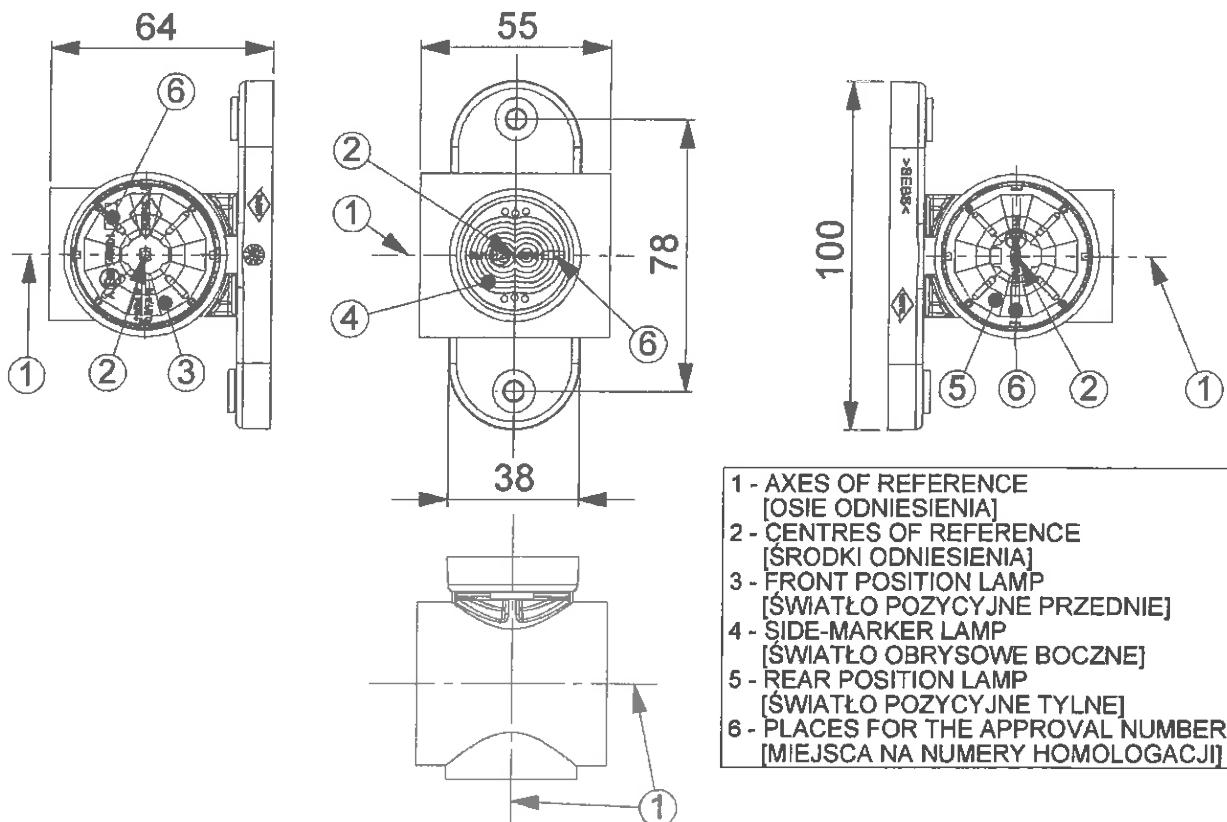
Rys. 11. Rysunek lampy HOR 77AG w wariantie LD 2186/GRAPHITE
