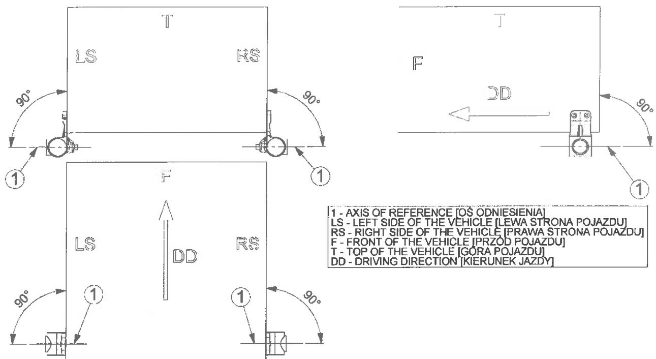
Rys. 21. Rysunek montażu lamp HOR 77AG w wariantach LD 3110/GRAFITE/P i LD 3110/GRAFITE/L na pojeździe
