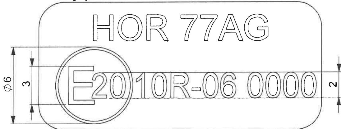
Rys. 14. Rysunek przykładowego znaku homologacji
