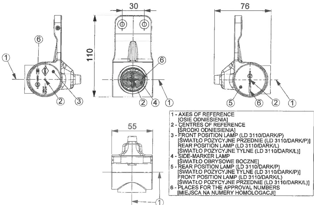
Rys. 13. Rysunek lampy HOR 77AG w wariantach LD 3110/GRAFITE/P i LD 3110/GRAFITE/L
