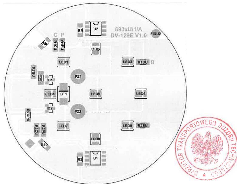
Rys. 5. Rysunek płytki drukowanej stosowanej do lamp HOR 102AG dla wszystkich wersji.
