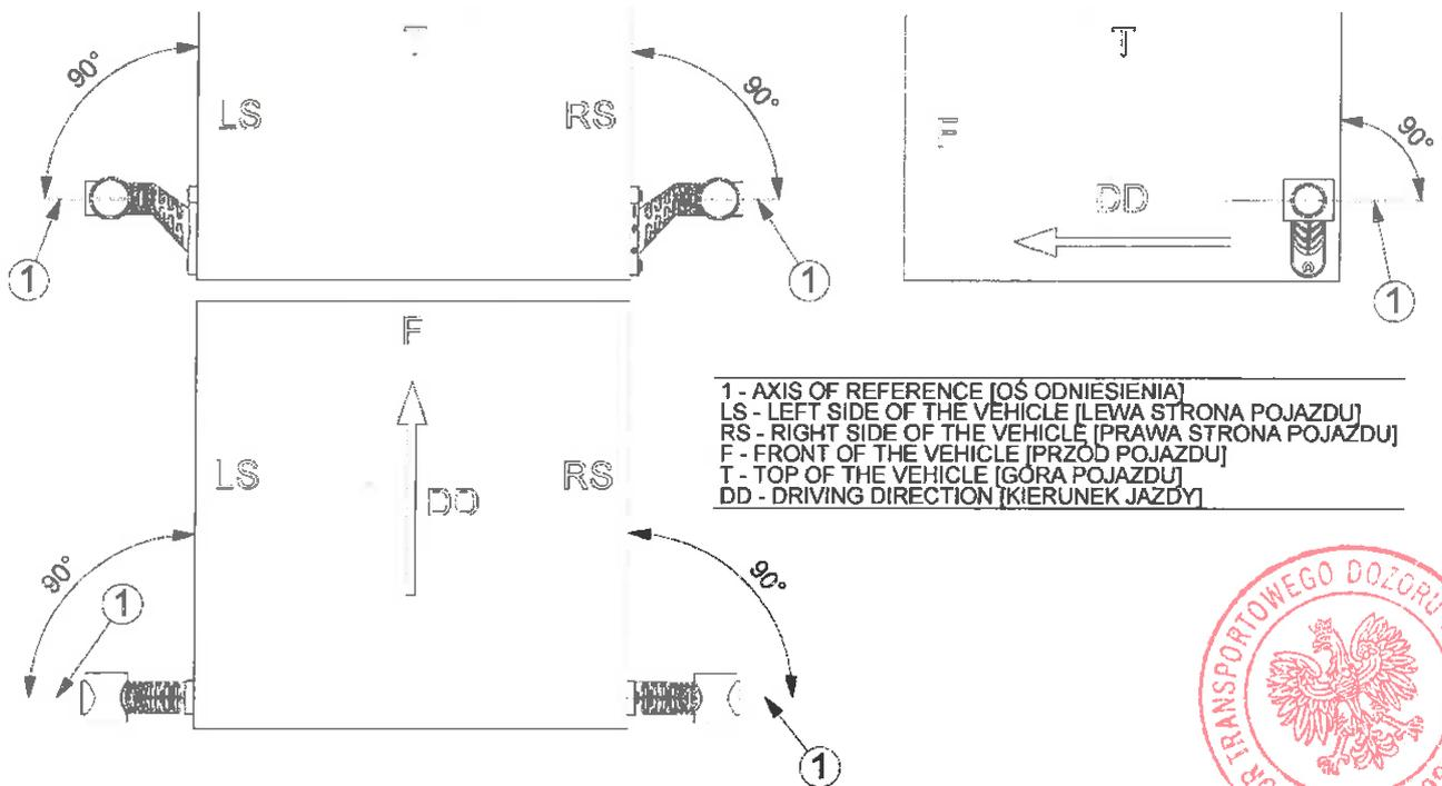
Rys. 18. Rysunek montażu lamp HOR 77AG w wariantach LD 2180/GRAPHITE i LD 2181/GRAPHITE na pojeździe
