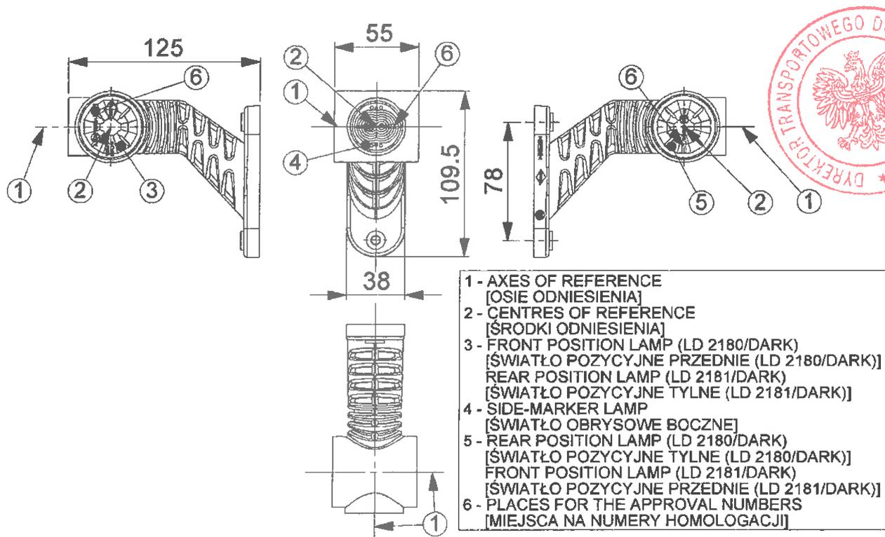
Rys. 10. Rysunek lampy HOR 77AG w wariantach LD 2180/GRAPHITE i LD 2181/GRAPHITE
