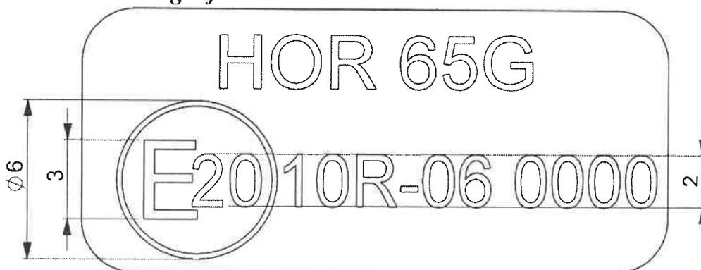
Rys. 6. Rysunek przykładowego znaku homologacji
